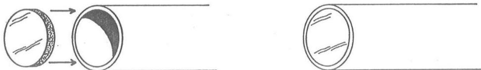
2. Perforar con la broca un orificio, cuyo centro esté a tres centímetros del borde en el que se ha instalado el tapón de madera. Luego, ampliarlo con ayuda de la lima hasta que tenga las siguientes medidas:
